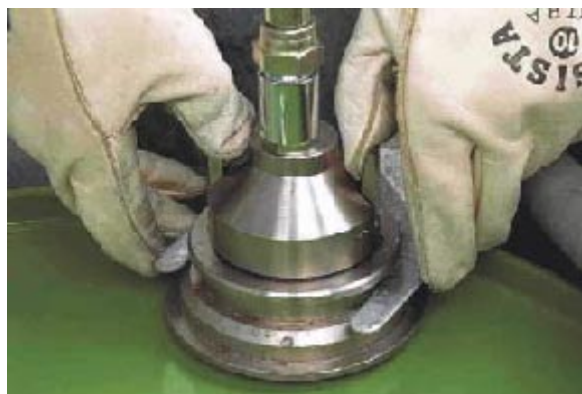
System bezúnikové rychlospojky s návratem par
